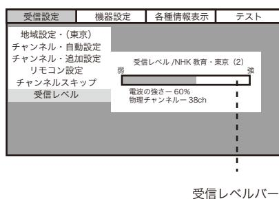
①アンテナの方向を調整し、受信レベルの電波の強さを55%以上にしてください。
