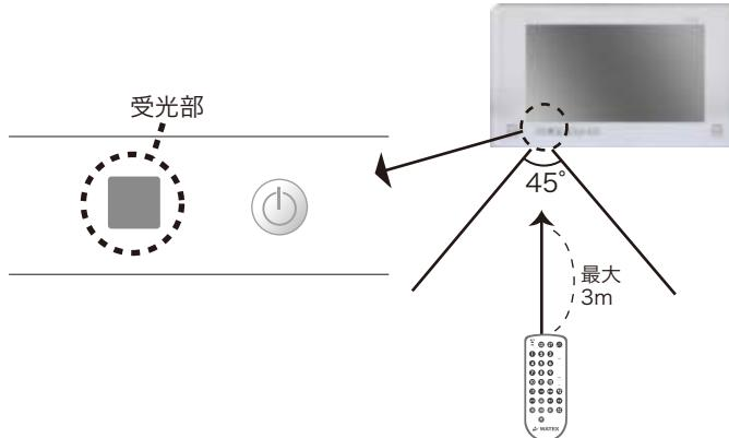
リモコンを本体のリモコン受光部に向け、受信可能角度（左右 45° 上下 30°）から操作してください。
